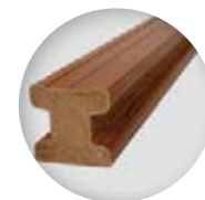
Legar z drewna kompozytowego: wyłącznie do deskowania na powierzchni płaskiej płyty betonowej. Wymiary w mm: 50 x 50 x 3000 lub 50 x 50 x 4000
